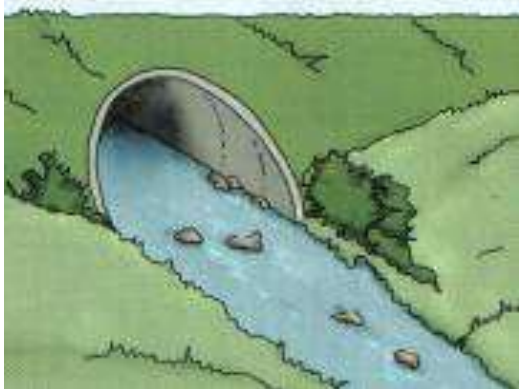
Rysunek 83 i Rysunek 84 Przepusty zagłębione [Przybyła 2002].
