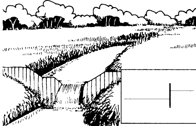
Rysunek 30. Prosty próg z pionowych desek z frezem [Pawlaczyk i in. 2005].
