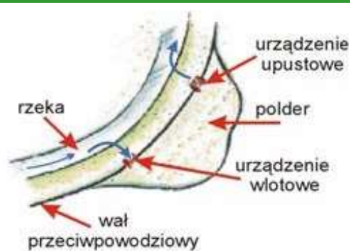
Rysunek 14. i Rysunek 15. Schematy działania polderów zalewowych [RZGW Kraków].
