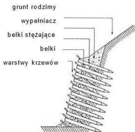
Rysunek 78. Przekrój poprzeczny kaszycy [Begemann i Schiechl 1999].
