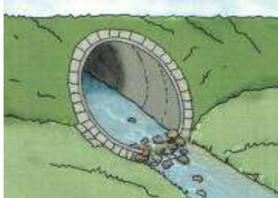
Rysunek 83 i Rysunek 84 Przepusty zagłębione [Przybyła 2002].
