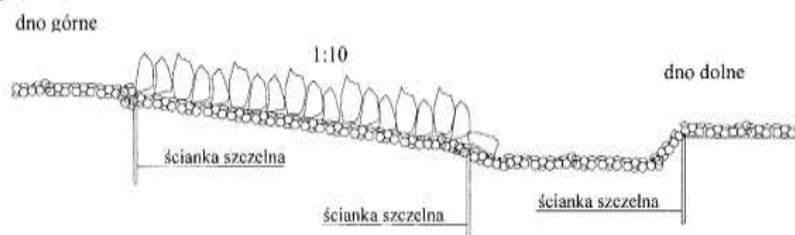
Rysunek 91. Schemat bystrza o zwiększonej szorstkości na rzece Kahl z ubezpieczeniem dna dolnego w formie niecki [Radecki-Pawlik 2008, 2009].
